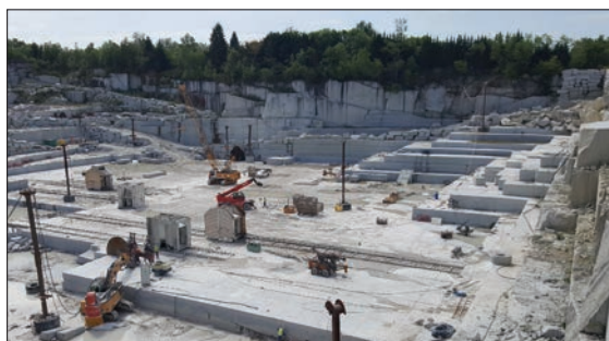
L'exploitation en carrière s'effectue notamment au grand disque et au fil diamantés.
