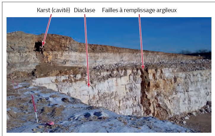
Front de taille avec failles et diaclases.
