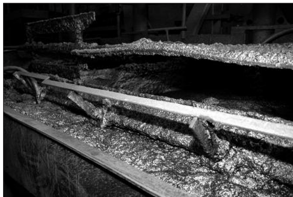
Figure 5 – Traitement de graphite par flottation (mine de Konstantin - République Tchèque © www.grafitovedoly.cz.)
