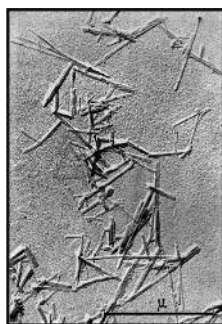
Sépiolite d'Eski Cheir, Turquie. Les microfibrilles de petites longueurs sont bien mises en évidence. [crédit M. Rautureau & A. Yucel, Journal de Microsc. & Spect. Elect., 1, 1976, 405-414]
