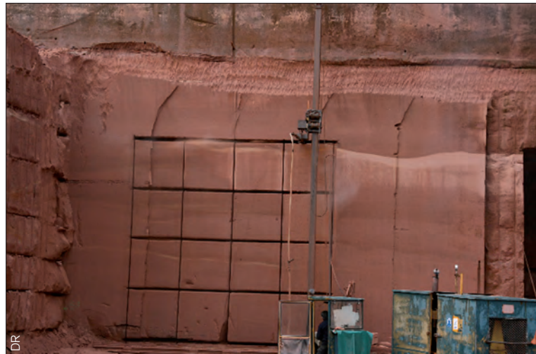
Découpe des blocs au Loegel-jet
