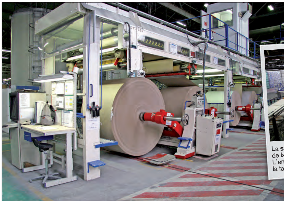
Vue de dessous, la table de fabrication déroule les feuilles cartonnées. Au-dessus, la pâte de plâtre est déposée sur la feuille qui formera le dos de la plaque
