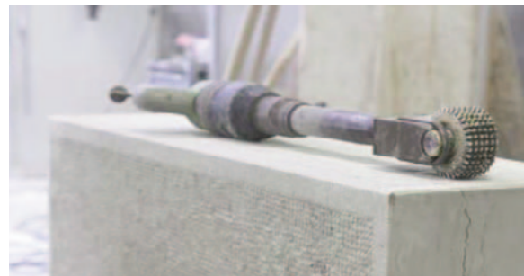
Travail de bouchardage sur une pierre de taille à l'usine des Carrières du Bugey. (38)
