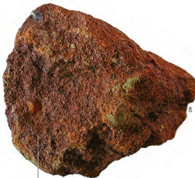
Minette de Lorraine. Le terme est un diminutif du mot mine, en raison de la teneur faible en fer et de la haute teneur en phosphore. La présence de ce dernier explique pourquoi ce minerai n'a été exploité qu'au milieu du XIX e siècle, après la mise au point du convertisseur Thomas autorisant une déphosphoration efficace.
