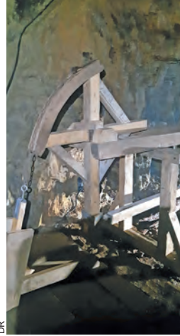
Mine Saint-Louis : reconstitution partielle du système de balanciers ou varlets, renvoyant vers la descenderie le mouvement alternatif des tirants créé par la roue hydraulique extérieure.
