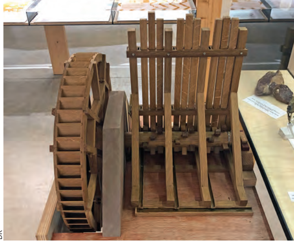
Maquette au 1/10 e d'un bocard du XVIII e siècle réalisée par Jean-Pierre Ithurreria : une batterie de pilons permettait de réduire en poudre le minerai impur et de réaliser un tri gravimétrique afin de le séparer de sa gangue de schiste et de quartz.
