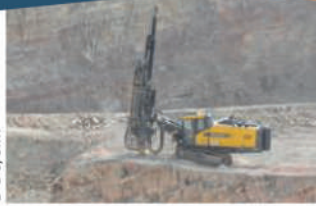
Foreuse équipée d'un dépoussiérage par aspiration
