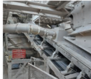
Système de dépoussiérage centralisé
