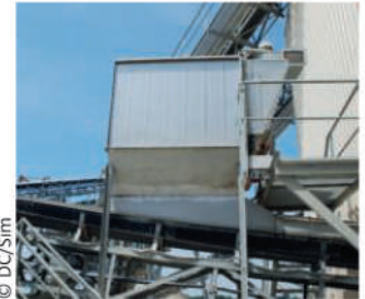
Dispositif de dépoussiérage ponctuel
