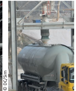
Chargement des fines dans une citerne à pulvérulents avec une manche télescopique dépoussiérée
