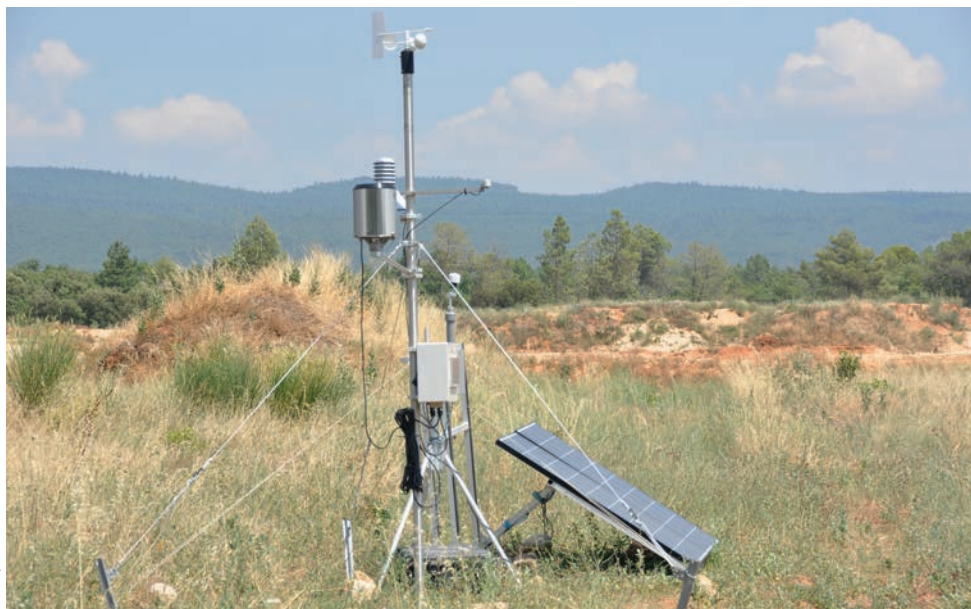
Région PACA - station de mesure expérimentale en périphérie de carrière : néphélomètre PM10 + station météo + batteries+ panneaux solaires
