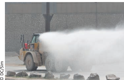
Arroseuse en action (tombereau articulé modifié)
