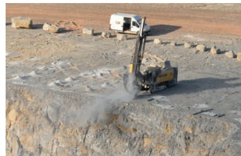
Carrière de grès-quartzite dans l'Ouest : foreuse en action
