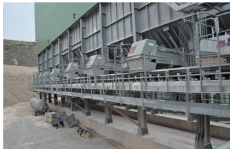
Carrière de grès - Bretagne : installation de traitement de granulats - Confinement d'un transporteur
