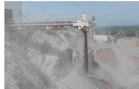
Carrière en Bourgogne : émissions de poussières à la mise en stock après concassage
