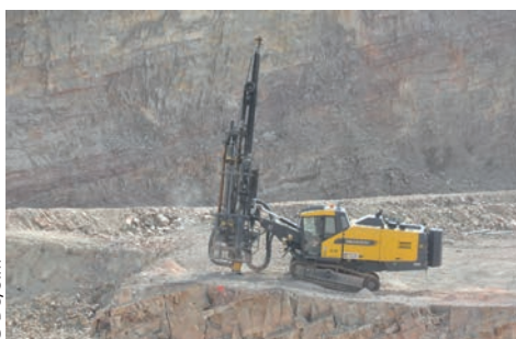
Carrière de calcaire : foreuse en action
