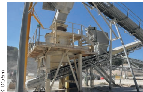
Dépoussiéreur ponctuel en sortie de concasseur
