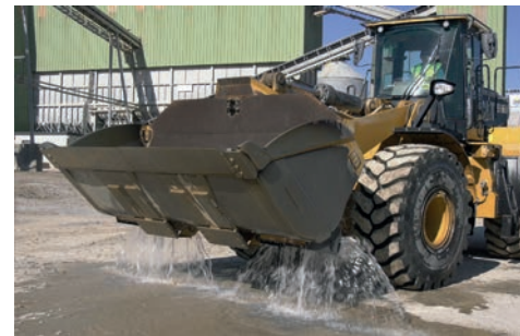
Godet de chargeur modifié pour mouillage des aires de circulation
