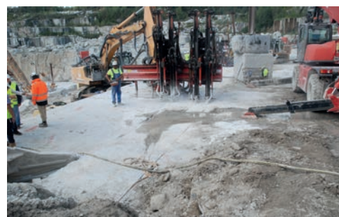
Carrière de granite ornemental dans le Sidobre : rang de quatre perforatrices montées sur bras de pelle hydraulique
