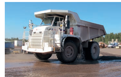
Benne de tombereau modifié pour mouillage des aires de circulation
