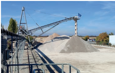
Stacker avec « échelle » anti-poussière
