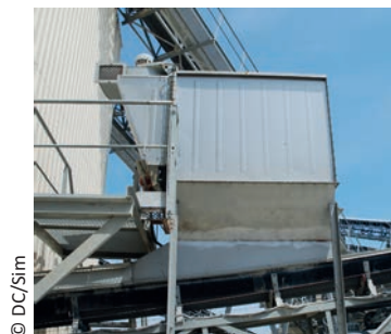
Dépoussiéreur ponctuel sur convoyeur après concassage
