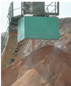
Stacker avec « échelle » anti-poussière
