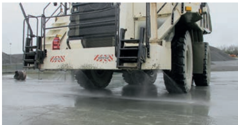
Système embarqué sur tombereau pour pulvérisation
