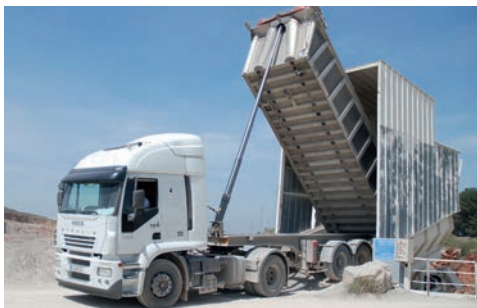
Trémie bardée sur trois faces pour limiter l'explosion aux vents
