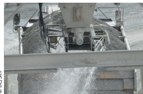
Rampes de pulvérisation autour d'un casque d'une trémie
