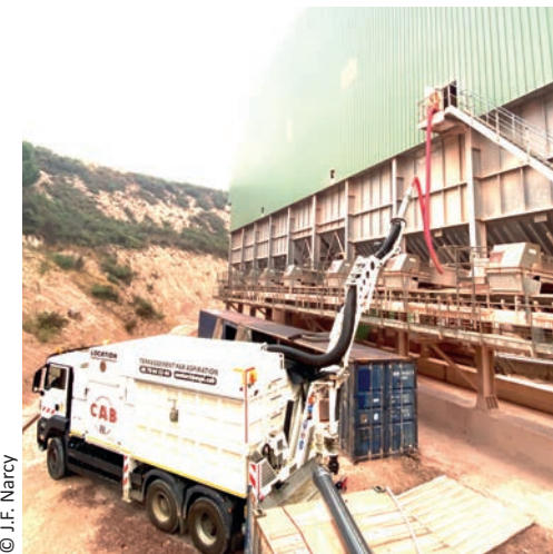
Véhicule aspirateur avec bras télescopique
