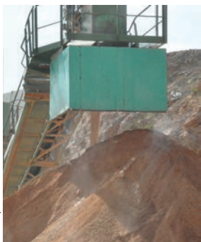
Stacker avec « échelle » anti-poussière
