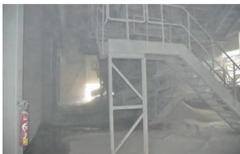
Installation de traitement : platelage de circulation encombré par l'accumulation de débordements et d'accumulation de poussières
