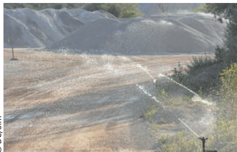
Nouvelle-Aquitaine : aspersion sur aire de circulation
