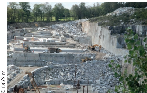
Sidobre : transfert de blocs de granite au chargeur ; des chutes et débris au tombereau articulé
