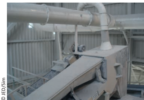
Installation de production de granulats : confinement et conduites de captage des flux d'air dans un dépoussiérage centralisé
