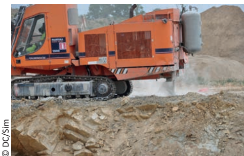
Rejet des fines en arrière de la machine
