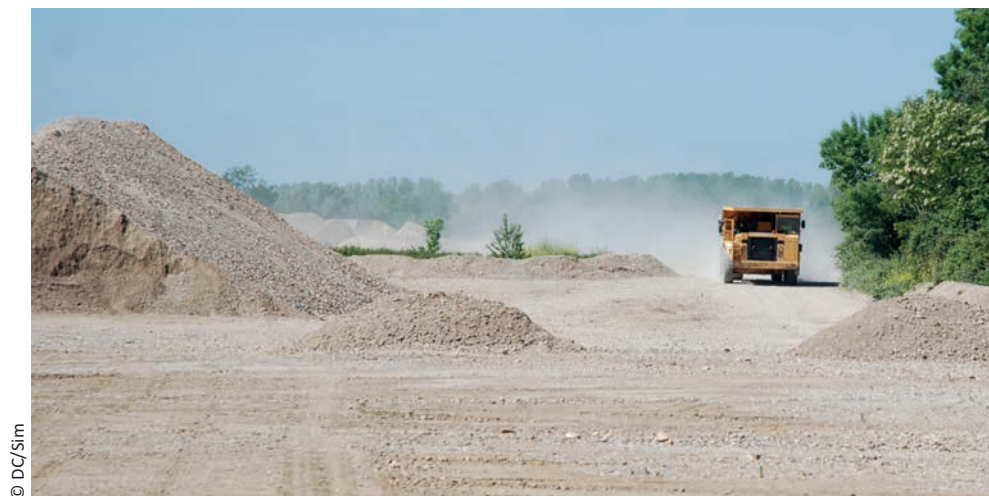
Nouvelle-Aquitaine : carrière de sables et graviers - transport des matériaux après égouttage par tombereau
