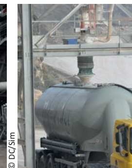
Chargement des fines dans une citerne à pulvérulents avec une manche télescopique dépoussiérée
