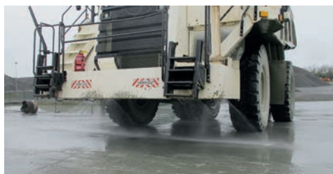
Système embarqué sur tombereau pour pulvérisation
