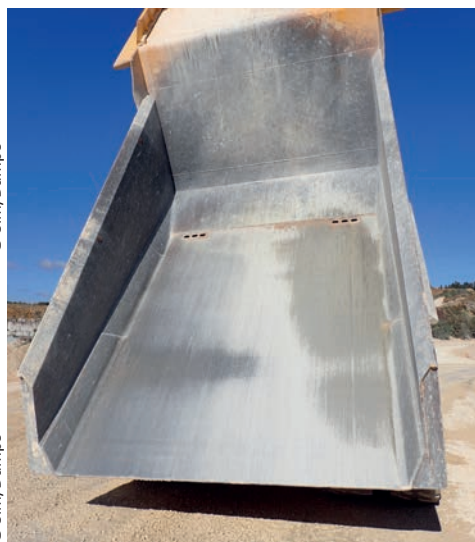
Modification de benne pour mouillage des aires de circulation
