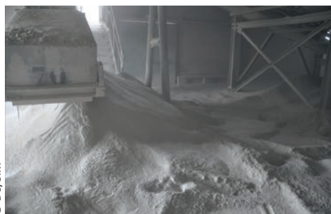
Installation de traitement : platelage de circulation encombré par l'accumulation de débordements et d'accumulation de poussières
