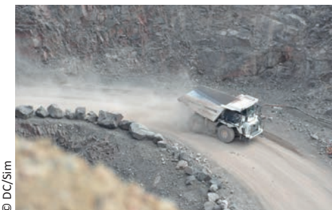
Carrière dans l'Ouest : émissions ponctuelles derrière un tombereau sur une piste sèche
