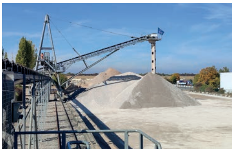
Stacker avec « échelle » anti-poussière
