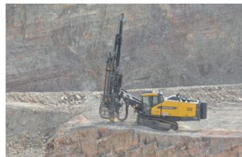
Carrière de grès - Bretagne : foreuse en action sur gradin avec dépoussiérage à la source et cabine isolée pour le foreur
