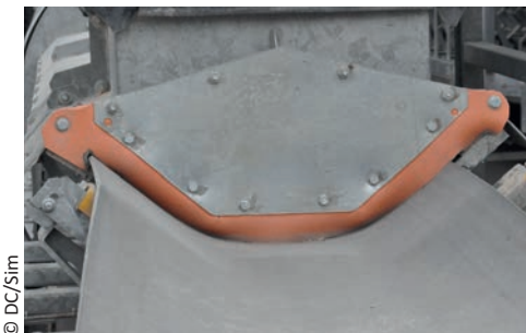
Bavettes d'étanchéité en partie basse d'une zone de chargement sur un convoyeur
