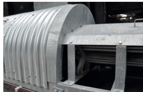
Détail de réalisation d'une liaison sur un convoyeur entre zone de chargement et zone de transport
