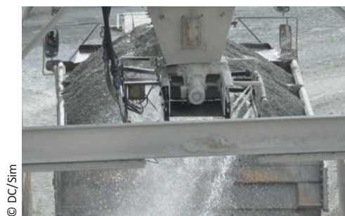
Rampes de pulvérisation autour d'un casque d'une trémie
