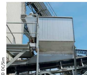
Dépoussiéreur ponctuel sur convoyeur après concassage
